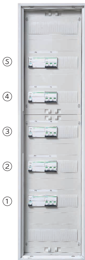
Verteilerschrank 5 × 11kW (FI Typ A 25A, LS 16A, HLAK 5p, einfeldrig)
